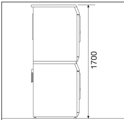
Для установки машин в колонну нужен соединительный монтажный комплект\*. Монтаж должен выполняться специалистом авторизованной фирмой Miele организации.
