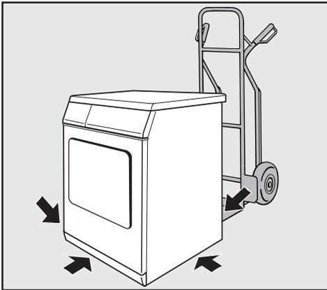
При перемещении машины Вы можете держать ее за выступающую заднюю часть крышки машины. Используйте для перемещения машины (с упаковочного поддона до места установки) передние ножки машины и задний выступ крышки.
