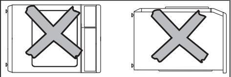
⚠ Если перевозка осуществлялась вопреки этому описанию, то тогда необходимо выдержать сушильную машину в **состоянии покоя** в течение примерно 1 часа, прежде чем подключать ее к сети электропитания. Иначе может быть поврежден тепловой насос!
