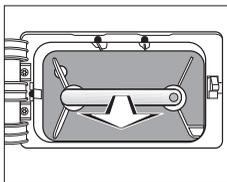
Фильтр в цоколе расположен внизу слева за монтажной крышкой. Этот фильтр задерживает тонкие ворсинки, волосы и остатки моющего средства, которые могут пройти через сетки ворсовых фильтров.
