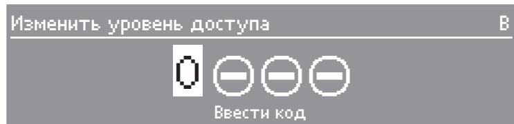
С помощью кнопок выбора **▲▼** изменяют вводимую цифру. Нажатием кнопки **OK** подтверждается введенная цифра и происходит переход к следующей позиции ввода.
